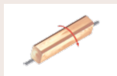
7 Blockvärdare 90° vändning av fyrsidiga block
