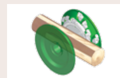
4 Reducerare VM 45 Delningsreducering av tvåsidiga block, produktion av fyrsidiga block och flis
