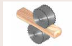
15 Dubbelaxlig cirkelsåg MKS Delningssågning av fyrsidiga block, produktion av bräder, plank och sidbräder
