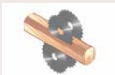
9 Sågaggregat CSMK 375-A2/B2 Delningssågning av fyrsidiga block, produktion av fyrsidiga block och sidbräder
