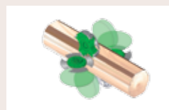
12 Profileringsaggregat VPM 450 Profilering av två sidobräder
