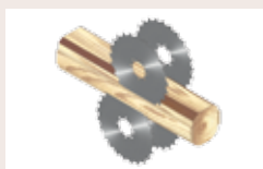
8 Sågaggregat CSMK 285-A1/B1 Kantsågning av tvåsidiga block, produktion av firsidi- ga block och sidobräder
