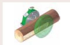
1 Reducerare VM 35 Reducering av stockar, produktion av tvärsidiga block och flis
