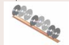
19 Kapsåg Kapning av sidbräder till önskad längd
