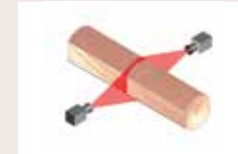
5 Blockmätssystem Återoptimering av sido- bränder, kontrollmätning av blocket
