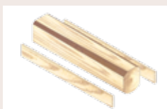
9 Separeringstransportör SEB Separering av sidobräder
