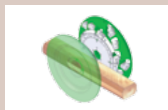
2 Reducerare VM 45 Reducering av tvåsidiga block, produktion av fyrsidi- ga block och flis
