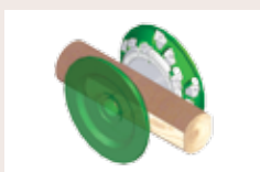
2 Reducerare VM 45 Reducering av stockar, produktion av tvåsidiga block och flis
