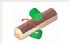
2 Blockvärdare DVS 35 90° vändning av tvärsidiga block
