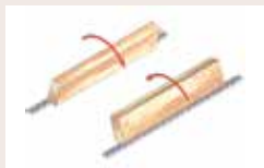
12 Blockvärdare 90° vändning av fyrsidiga block
