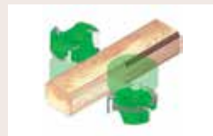
8 Profilerings- och såg-aggregat VPS 35 Profilering och sågning av två sidbräder
