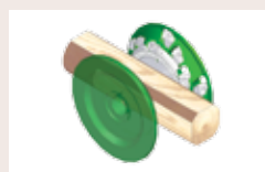
4 Reducerare VM 45 Reducering av tvåsidiga block, produktion av firsidi- ga block och flis
