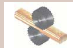
5 Sågaggregat CSMK 285-A2/B2 Delningssågning av fyrsidiga block, produktion av plank och sidobräder
