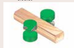
14 Profileringsaggregat VPF 340 Profilering av två sidbräder
