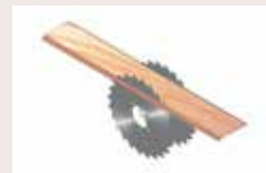
18 Kantverk Kantning av sidbräder
