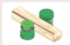
11 Profileringsaggregat VPF 340 Profilering av två sidobräder
