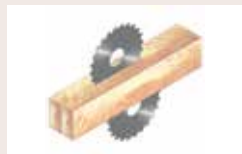
11 Klyvcirkelsåg TS 35 Klyvning av fyrsidiga block
