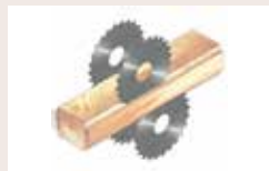
9 Profilerings- och såg-aggregat VPS 35 Profilering och sågning av två sidbräder
