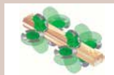
3 4 Profileringsaggregat VPM 450/N Profilering av två sidobräder
